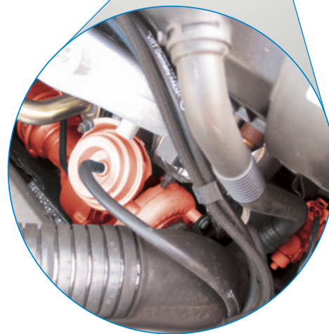
Druckwandler und VTG-Lader (rot hervorgehoben) im Audi A4 TDI
